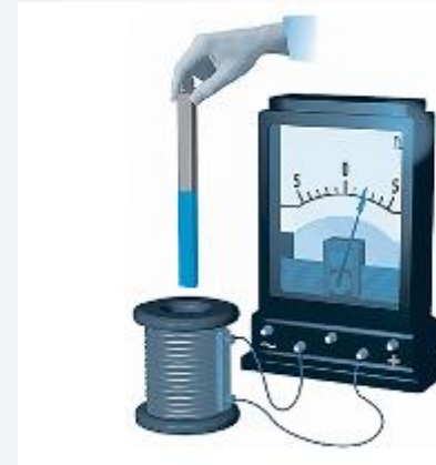
Возникновение тока при действии пост. магнита на катушку
